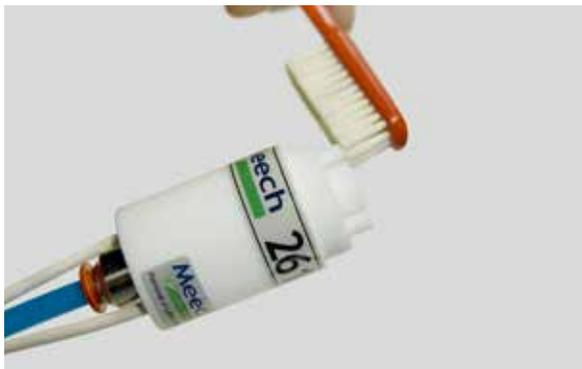
Die Ionisierstäbe müssen regelmäßig abgewischt werden, um die grauen Ablagerungen von der Oberfläche des Stabes zu entfernen. Es wird empfohlen hierfür einen befeuchteten Lappen mit einer kleinen Menge IPA oder Brennspritus zu verwenden.
