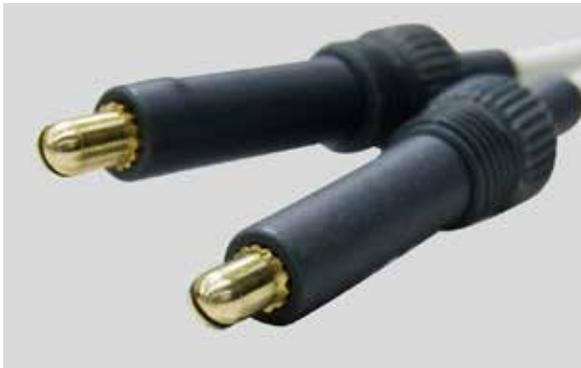
Wenn das der Fall sein sollte, (1) wenn die Anschlüsse zu eng sind, sollten Sie die beiden Hälften des Messing-Endes leicht mit einer Zange zusammendrücken. (2) Wenn die Anschlüsse zu locker sind, öffnen Sie den Schlitz am Ende des Kabels leicht mit einem Schraubenzieher oder Messer.
