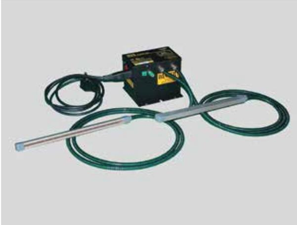
Das Netzteil wandelt den Eingangsnetzstrom in einen Hochspannungsstrom mit niedriger Stärke um. Dieser Strom wird über das HS-Kabel an den 914 Ionensprühstab geleitet.
