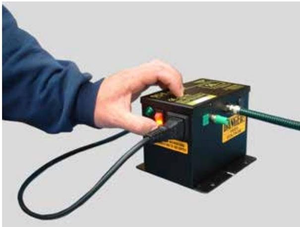
2. Trennen Sie alle Ionensprühstäbe von der Stromversorgungseinheit.
