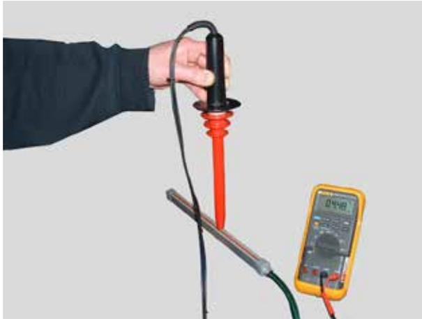
6. Wenn die Spannung bei unter 4,0kV liegt, sollte der Stab an Meech zurückgesandt werden, um entweder Wartungsarbeiten und/oder Reparaturen durchzuführen.
