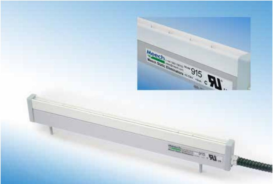
Der Meech 915 AC-Ionensprühstab wurde entwickelt um anspruchsvollste elektrostatische Probleme zu beheben. Durch die Widerstandskopplung der Elektroden an die Hochspannung, ist der Stab trotz des hohen Wirkungsgrades berührungssicher. Dies ermöglicht den Einsatz bei hohen Ladungen und hohen Bahngeschwindigkeiten mit zugleich höherer Reichweite als dies bisher möglich war.
