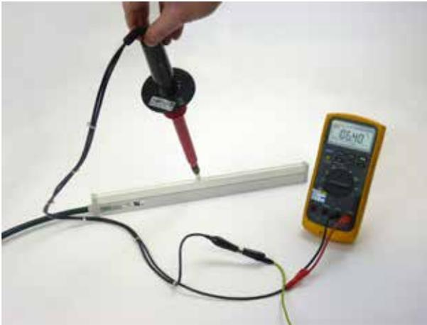
6. Wenn diese Spannung unter 4,0kV liegt, muss der Stab zur Kontrolle/ Reparatur an Meech zurückgeschickt werden.
