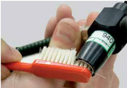
Die Ionisiergeräte müssen regelmäßig abgewischt werden, um die grauen Ablagerungen von der Oberfläche zu entfernen. Es wird empfohlen hierfür einen befeuchteten Lappen mit einer kleinen Menge IPA oder Brennspiritus zu verwenden.
