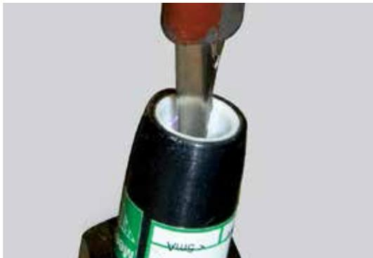
8. Man könnte auch den Stat Stick von Meech verwenden: es reicht schon ihn in einer Entfernung von ungefähr 50 mm von der Elektrode zu bewegen; leuchtet die Sonde auf, funktioniert die Ionensprühdüse normal.
