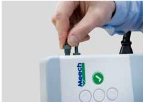
6. Bei Gebrauch derselben Messgeräte, die Spannung der Stabelektroden überprüfen. Die gemessene Spannung muss sich zwischen 3kV und 6kV befinden.
