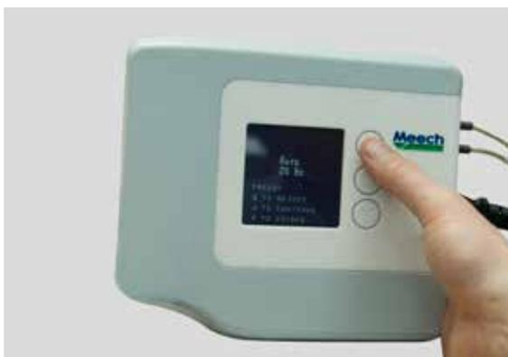
Wenn der Stab auf einer größeren Distanz zum Zielobjekt platziert wird (600-750mm), muss die Frequenz (RATE) niedriger geregelt werden. Wenn der Stab in einem geringeren Abstand zum Objekt angebracht wird (150-300mm), dann muss die Frequenz (RATE) höher eingestellt werden.
