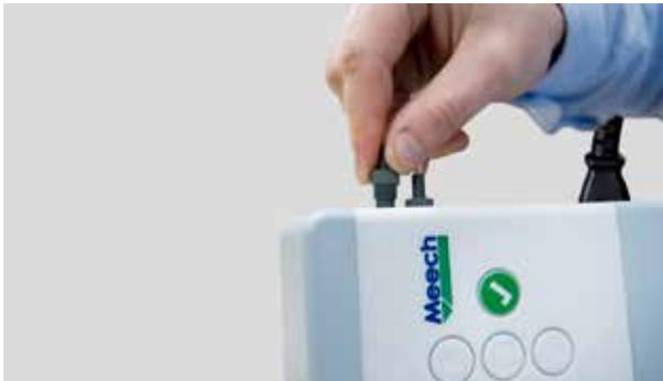
Das Netzteil anschließen und einschalten. Der Hyperion 971 produziert jetzt eine gepulste DC-Ionisierung an seinen Elektroden.
