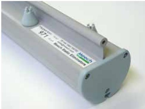
Das abgerundete Profil des Hyperion 971 Ionisierstabes minimiert den Staubabsatz und ist somit für den Einsatz in Reinnräumen geeignet. Der Stab ist stabil und kann daher auch auf großen Breiten verwendet werden. Die Anbringung erfolgt durch M4x20 T-Bolzen in einer Nut auf der Rückseite des Stabes.
