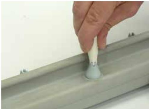
Falls die Elektroden bei einer Wartung sehr verschmutzt oder beschädigt sind, sollten sie ersetzt werden. Ersatz-Elektroden sind erhältlich bei Meech Static Eliminators Ltd. oder bei ihrem Meech Vertreter vor Ort.
