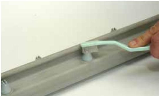
Die Ionisierstäbe müssen regelmäßig abgewischt werden, um die grauen Ablagerungen von der Oberfläche des Stabes zu entfernen. Es wird empfohlen hierfür einen befeuchteten Lappen mit einer kleinen Menge IPA oder Brennspritus zu verwenden.
