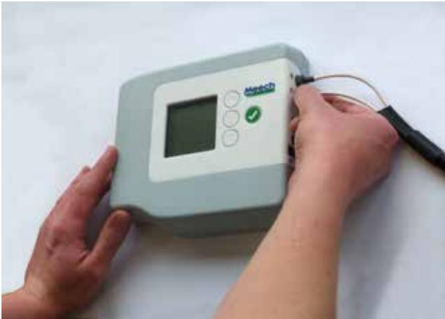
4. Das IEC Stromkabel anbringen. Es können Eingangsspannungen von 100V-240V, 50 oder 60Hz verwendet werden.
