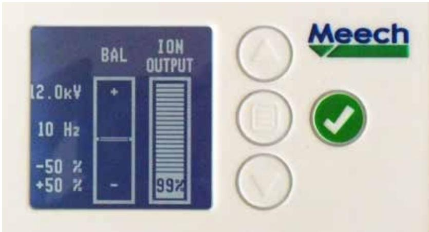
3. Mithilfe des Displays wird die korrekte Ausgangsspannung (Seite 9), sowie die Frequenz (Seite 11) eingestellt.
