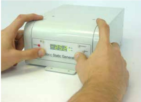
Um das Stromlimit anzupassen (von 0 – 500 $\mu$ A), drücken und halten Sie den „Constant I“ Knopf und benutzen Sie + oder – um den gewünschten Strom einzustellen. Wenn der „Constant I“ Knopf losgelassen wird, dann gibt das Display den vom System abgegebenen Strom wieder.
