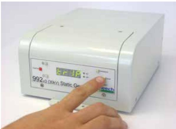
Wenn der 992v3 im Trip-Modus steht kann das Gerät auch neu gestartet werden, indem man den EIN/ AUS Schalter auf der Rückseite des Generators betätigt.
