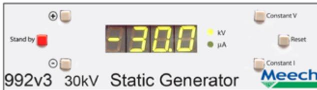
Display des 992v3 im Konstante Spannung-Modus
