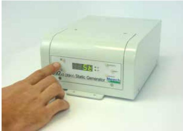
In der Stand By-Funktion sind die Ausgänge des Generators ausgeschaltet. Dies erlaubt dem Bediener den Aufladestab zu reinigen oder anders zu positionieren.
