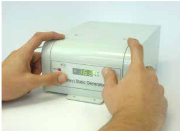
Um die Ausgangsspannung anzupassen (von 0-30 kV), drücken und halten Sie den „Constant V“ Knopf und benutzen Sie + oder – um die gewünschte Spannung einzustellen.
