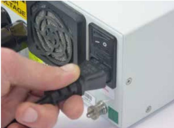
Der Generator ist mit einem integrierten Wechselmodus für die Stromversorgung ausgestattet; auf diese Weise kann das Gerät mit Strom von 85 bis 265V, 50Hz oder 60Hz gespeist werden.
