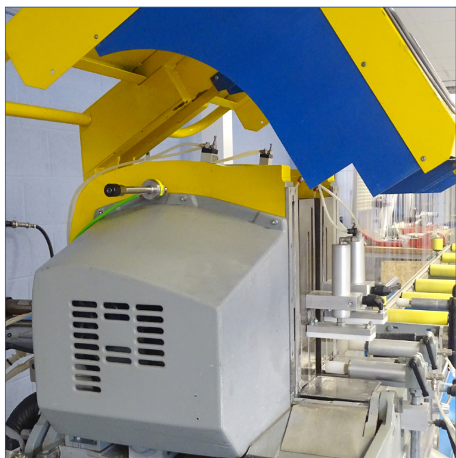
用于冷却锯片的涡流管。
