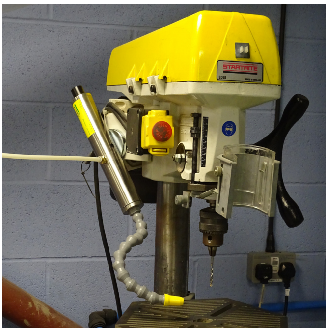
适用于冷却钻孔过程的可调冷气流喷枪。
